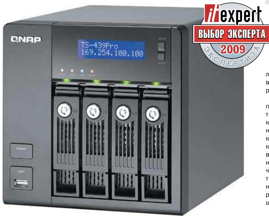
**В** сетевом хранилище QNAP TS-439 Pro множество нововведений по сравнению с предыдущим поколением NAS от QNAP Systems: выход на внешний монитор, платформа Intel Atom (впервые в устройстве данного класса).
